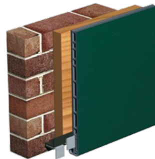
Boeiboord montage zonder overstek met profiel 2871 en montageclip 2872
